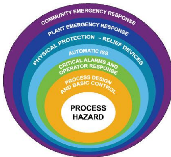
Figura n.1.5 Organizzazione di PL/IPL in un contesto impiantistico
