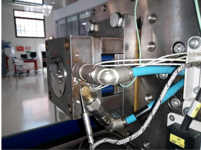
FIGURA 5.20 - DETTAGLIO DEL SISTEMA VARIOTERMICO DELLO STAMPO. ALL'INTERNO DEI TUBI AZZURRI SCORRE IL LIQUIDO DI RAFFREDDAMENTO, MENTRE IL CAVO GRIGIO ALIMENTA LE TERMORESISTENZE.
