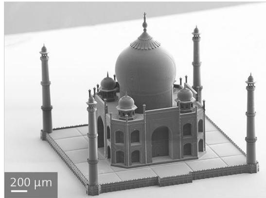
FIGURA 1.1 - SCANSIONE AL SEM DEL TAJ MAHAL, UN ESEMPIO DIMOSTRATIVO DEL DETTAGLIO E DELLA RISOLUZIONE RAGGIUNGIBILE DALLA TECNOLOGIA DLW.
