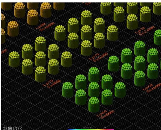
FIGURA 6.2 - DETTAGLIO DEGLI ELEMENTI DI UNA MATRICE. SI PUÒ OSSERVARE COME LA SCALA DI COLORI RAPPRESENTI DIVERSE POTENZE IN L'USCITA DEL FASCIO LASER.
