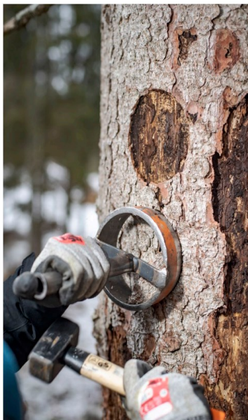
Figura 6 – Prelievo dei campioni con l'utilizzo dell'estrattore
