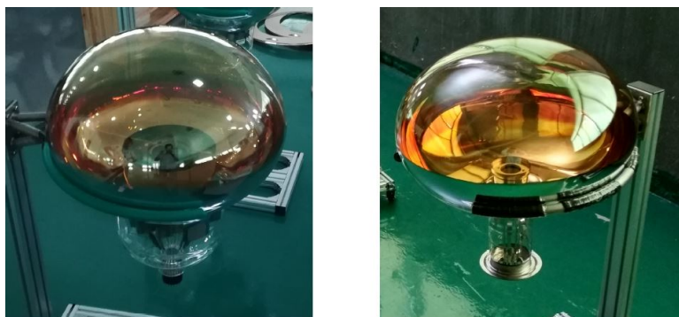
Figura 1.8: Due tipi di fotomoltiplicatori da 20 pollici. Quello di sx è quello con dinodi mentre quello di dx sono MCP-PMT.
