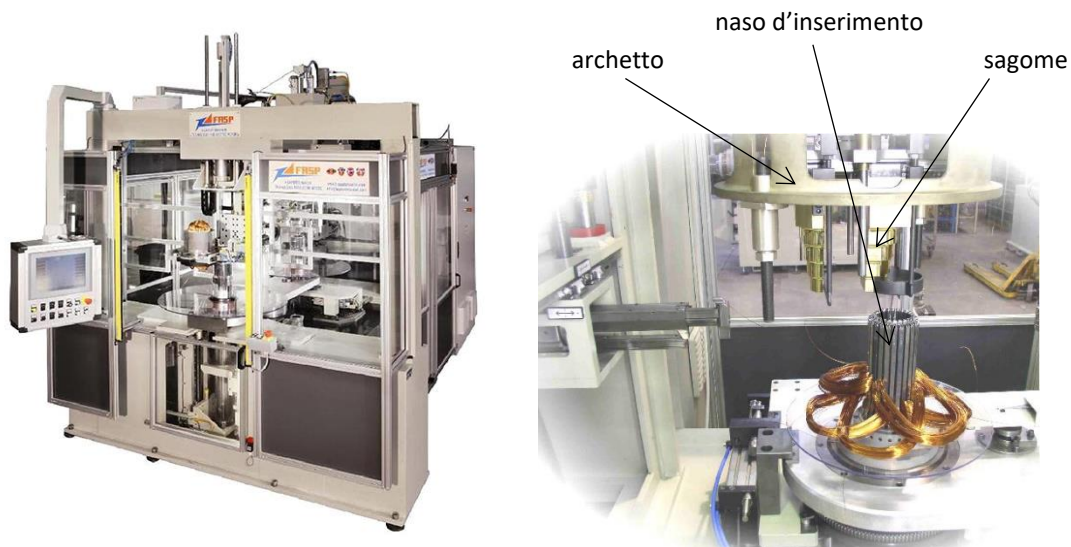
Figura 2.9- Transfer e particolari di avvolgimento
