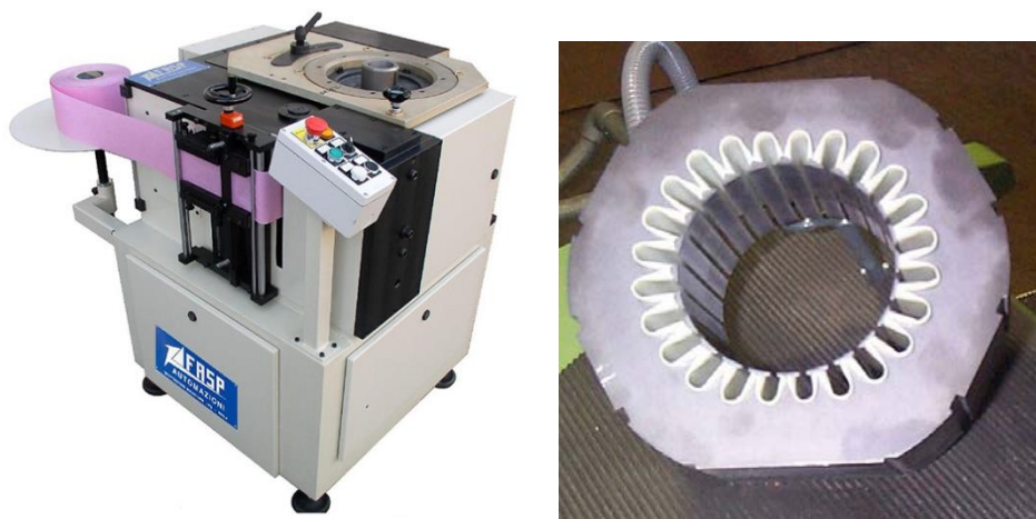
Figura 2.8- Isolatrice e statore isolato
