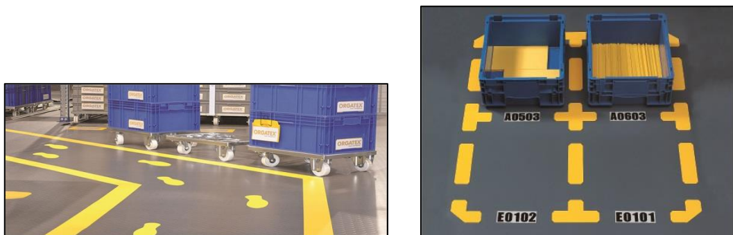
Figura 4.7- Percorsi e linee di separazione a terra
