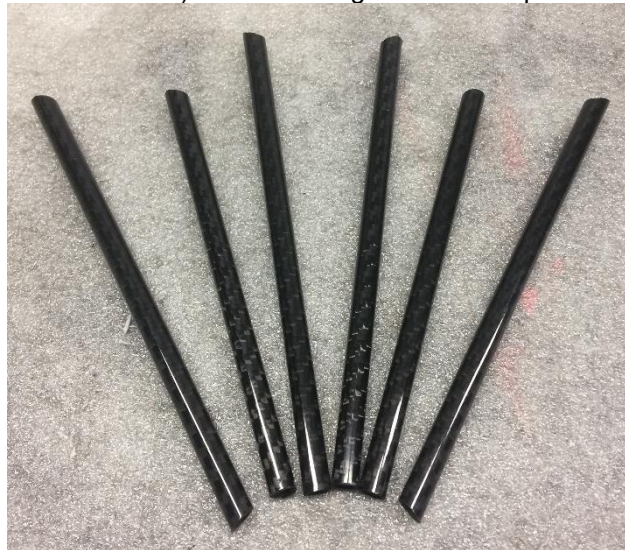
Figura 3.49: Taglio e intestatura tubetti in carbonio.
