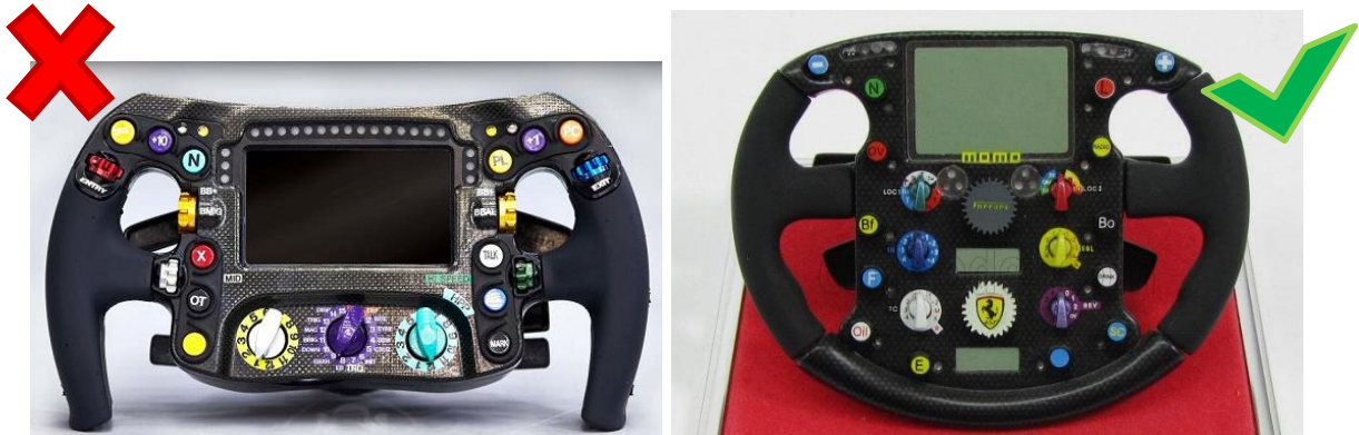
Figura 3.53: Geometria volante conforme con il regolamento FSAE a destra; non conforme a sinistra (concavità, perimetro discontinuo).
