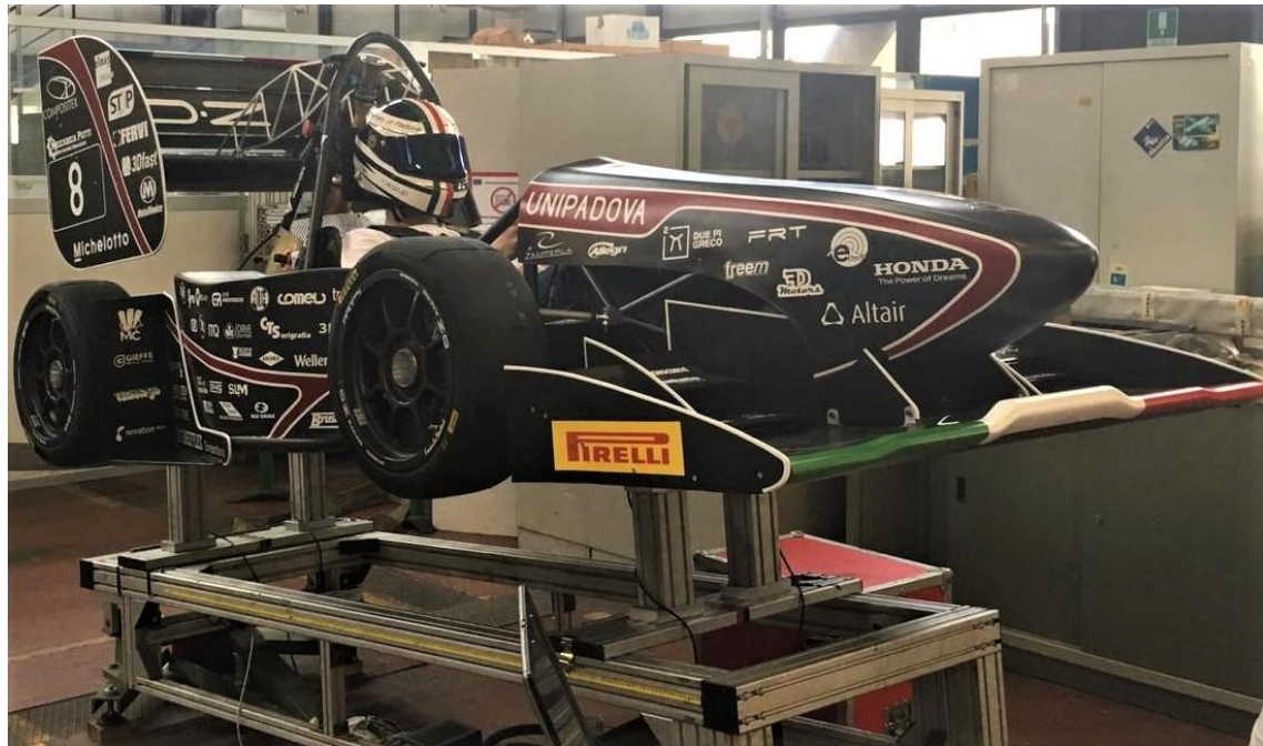
Figura 3.4: Mg14.19 nel banco di misurazione baricentro vettura [14].
