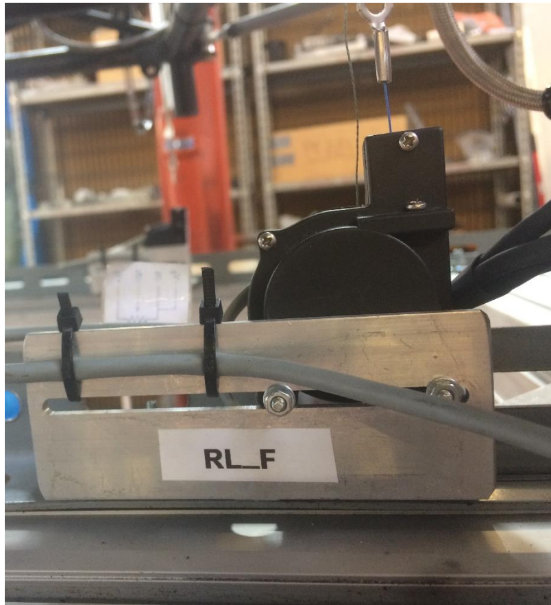
Figura 7.45: Potenzimetro in corrispondenza del gruppo posteriore sinistro, attacco avanzato.
