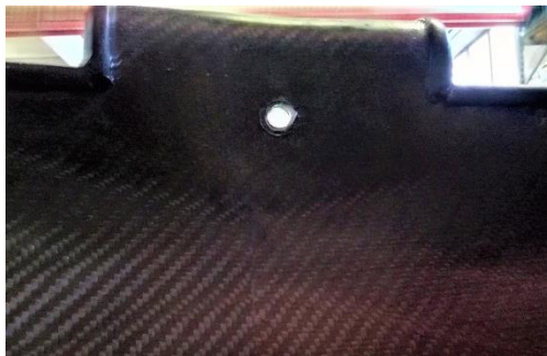
Figura 3.42: Fori per attacchi sedile con patch di Kevlar.
