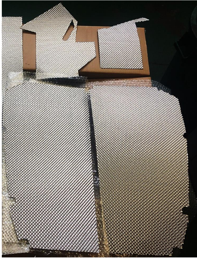
Figura 3.24: Lamine di alluminio gofrato tagliate secondo disegno CAD.
