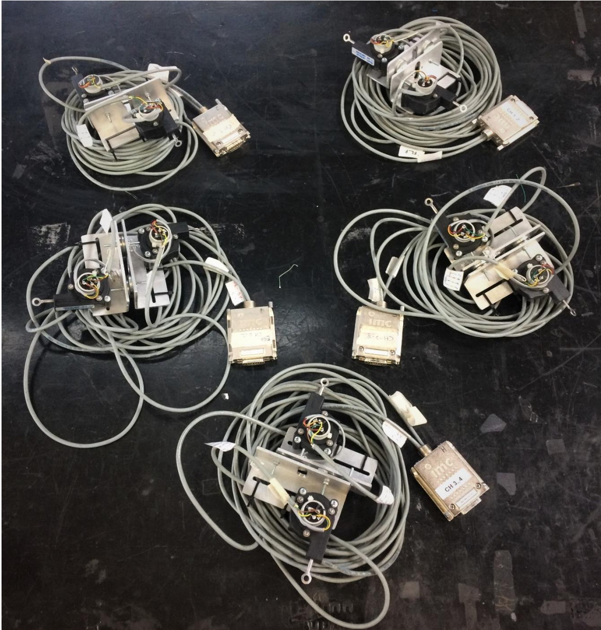
Figura 7.19: Cablaggio potenziometri ultimato.
