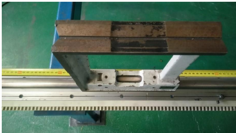
Figura 4.4: Verifica della planarità delle guide del banco.
