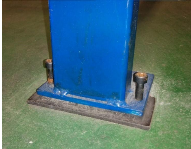
Figura 4.5: Piedi del banco regolabile mediante viti.
