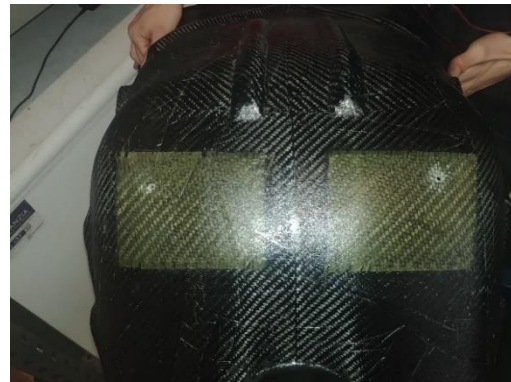
Figura 3.42: Fori per attacchi sedile con patch di Kevlar.
