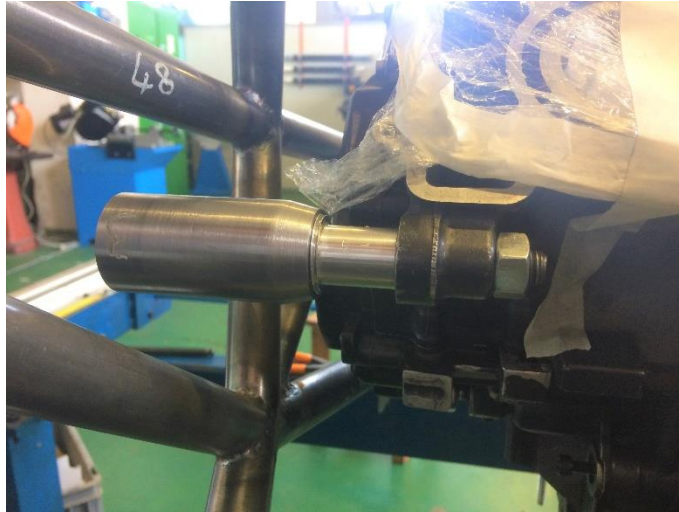
Figura 4.16: Attacco motore frontale sinistro.
