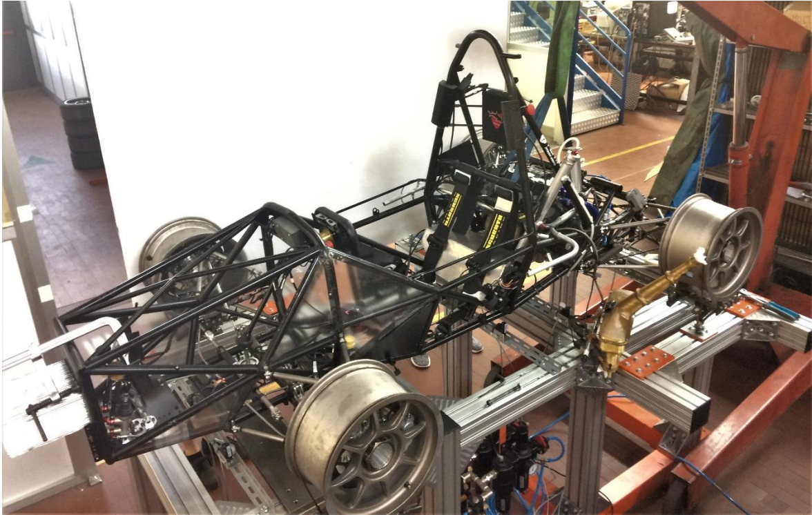
Figura 7.43: Configurazione finale telaio per le prove sperimentali.
