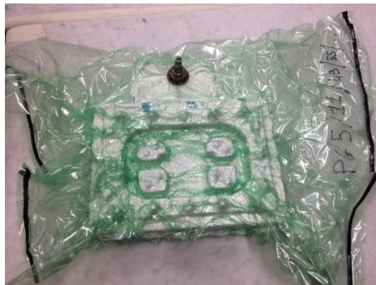
Figura 3.67: Sacco a vuoto volante.
