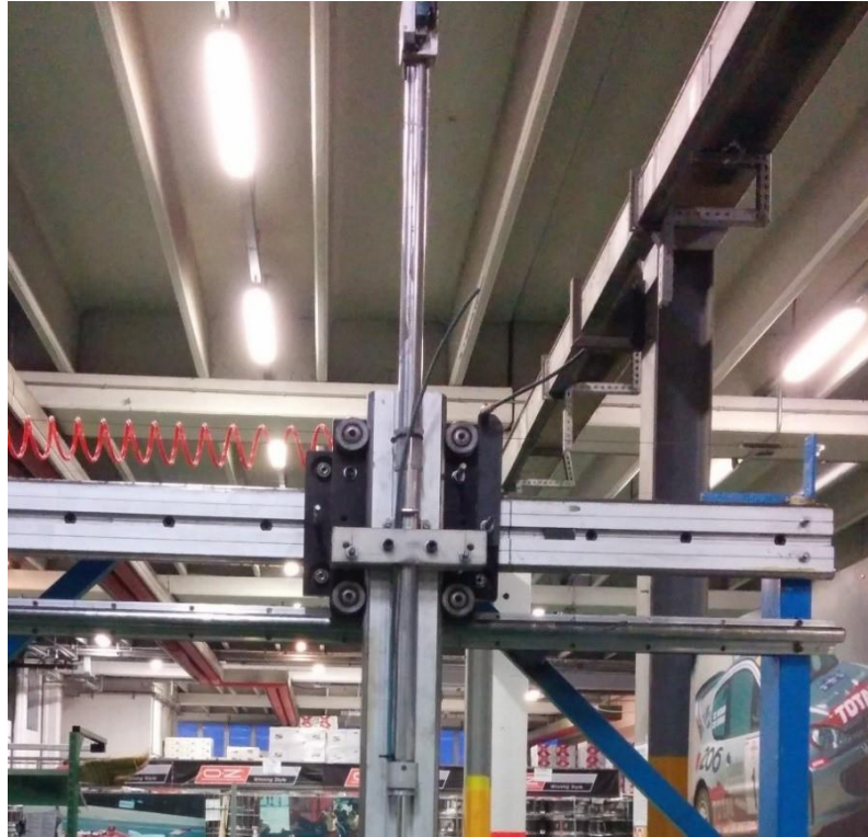
Figura 4.3: Guida verticale con circuito pneumatico per azzerare la forza peso della barra di riferimento.
