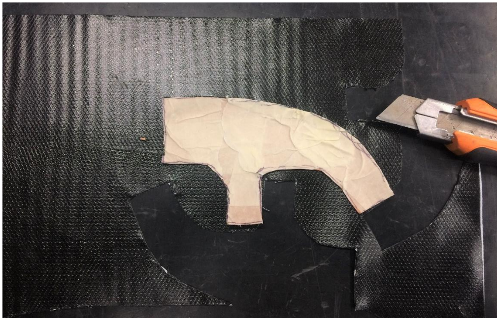
Figura 3.65: Gomma vulcanica per impugnatura.
