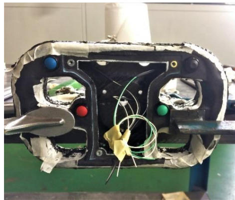
Figura 3.70: Incollaggio semi gusci.
