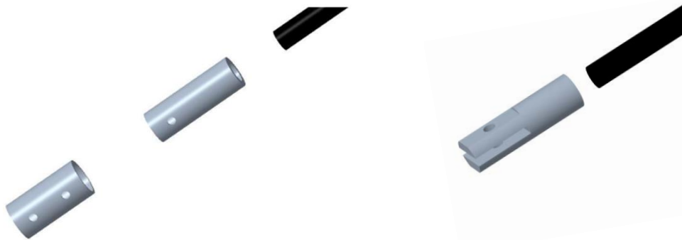
Figura 3.47: Soluzione 2018 con due boccole d'alluminio, la prima incollata al tubo in carbonio che si connetteva all'altra tramite rivetto; la seconda che si fissava con l'attacchino di sezione circolare al MH tramite il secondo rivetto (a sinistra); Soluzione 2019, una sola boccola incollata al tubo in carbonio che si fissava all'attacchino di sezione rettangolare al MH tramite un solo bullone (a destra).
