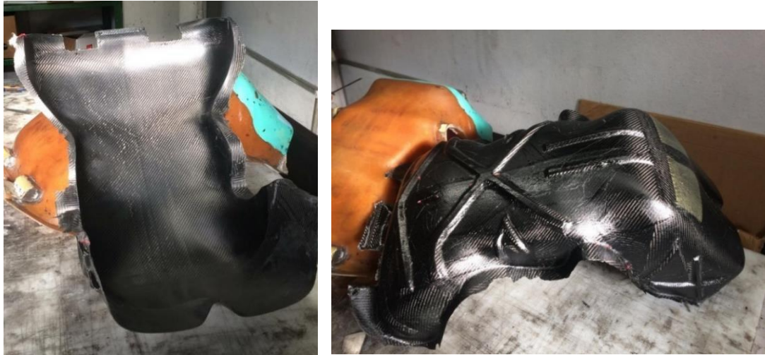
Figura 3.44: Rimozione sedile dallo stampo.
