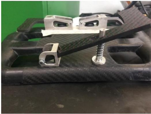
Figura 3.68: Incollaggio sistema paddle e frizione.
