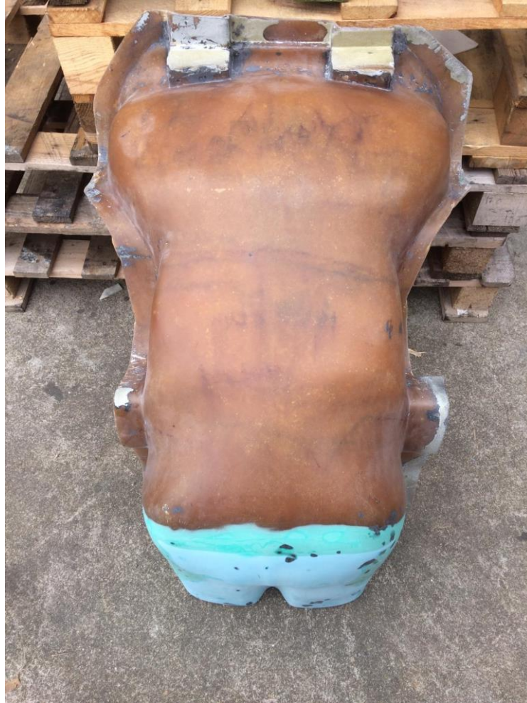
Figura 3.38: Stampo sedile con inserto in resina epossidica incollato.
