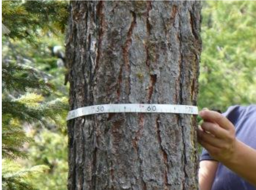
Fig. 2c. Misurazione del diametro dei fusti a 1,30 m di altezza con apposita rotella metrica.
