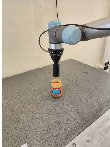
Figura 5.4: Setup dell'esperimento per il calcolo della viscosità del burro di arachidi.
