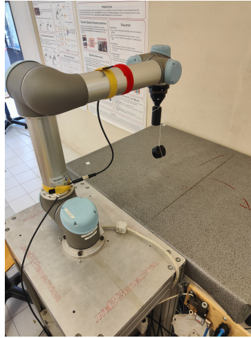
Figura 5.2: Setup sperimentale per la misurazione del peso lungo l'asse z .
