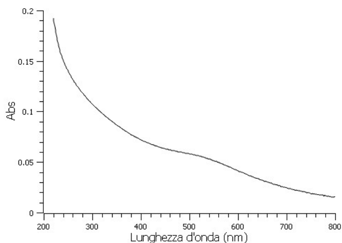
Figura 72: Spettro UV-Vis di una soluzione 0.1 mg/mL di 1-AuNP in H 2 O.
