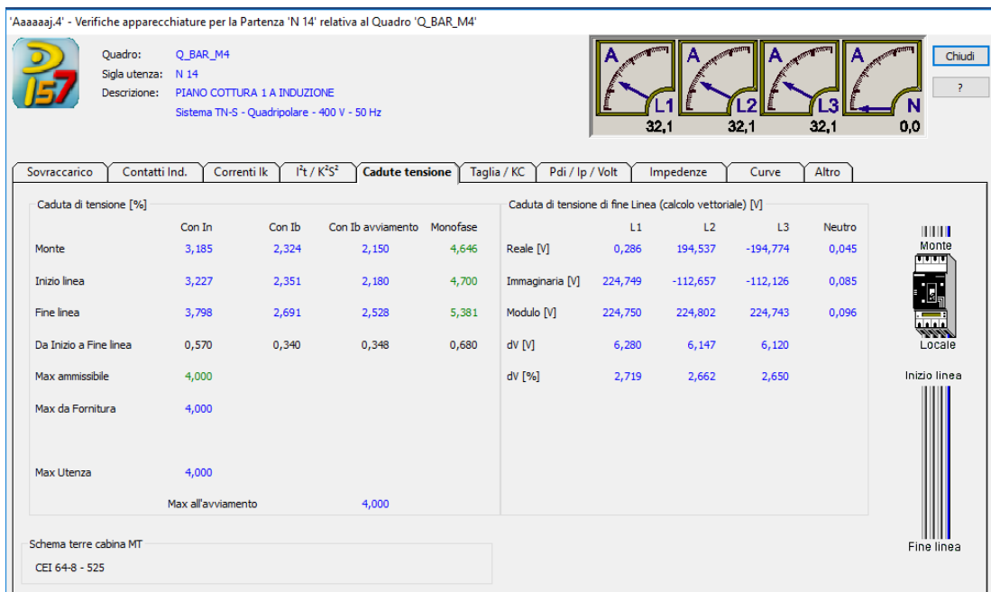
Fig. 9.8 - Verifica della caduta di tensione
