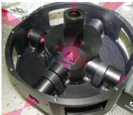
Figura 2.2: Realizzazione opto-meccanica di AquEye e IquEye. Sopra la piramide il pinhole definisce l'apertura del cielo e l'allineamento del banco ottico. Sono visibili i 4 canali alla fine dei quali vengono posizionati i detectors.
