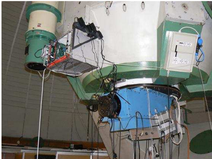
Figura 2.1: Aqueye (sotto) e la sua versione aggiornata Aqueye+ (sopra) installati al telescopio Copernico di Cima Ekar, ad Asiago.
