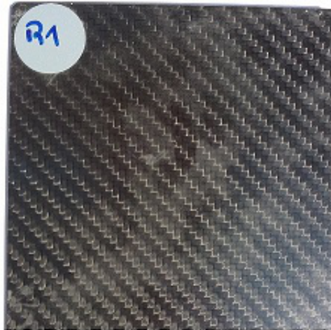
Figura 4.3: Immagine di un provino in fibra composita di carbonio fornito dalla BSCT .
