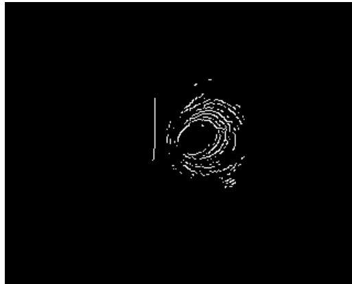
Figura 5.67: Immagine che individua i contorni di interesse individuati come prodotto tra l'immagine binaria di Canny 5.66 e del threshold del gradiente 5.65.
