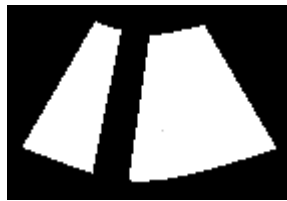
Figura 5.16: Immagine binaria della maschera geometrica per analizzare solo la superficie dell'oggetto da analizzare. In questo modo si evita di analizzare la scanalatura presente sulla superficie e le zone dell'ambiente circostante.
