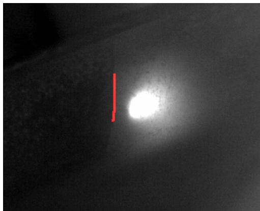
Figura 5.72: Immagine finale dell'algoritmo in cui viene segnalato in rosso la cricca sull'immagine originale.
