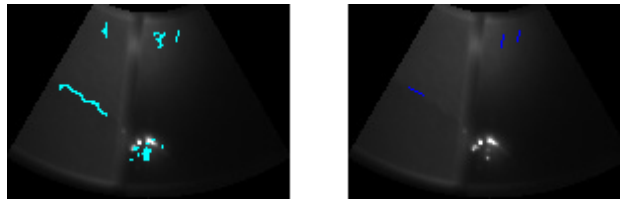
Figura 5.24: Immagini risultanti dall'algoritmo Iron Crack utilizzando un'immagine in fase di riscaldamento. A sinistra in ciano sono rappresentati i punti appartenenti a possibili difetti mentre a destra in blu sono riportate le linee identificate che si reputano appartenere a delle cricche.
