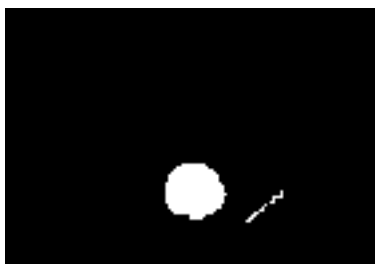
Figura 5.57: Immagine binaria ottenuta dall'identificazione dei bordi dell'immagine 5.56, eliminando quelli di lunghezza inferiore a 8 pixel, e disegnando le aree che delimitano.
