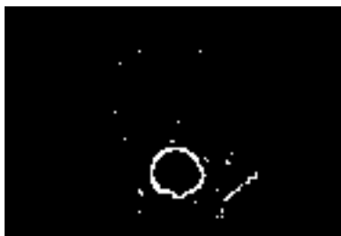
Figura 5.56: Immagine binaria dei punti di interesse: ottenuta dalla moltiplicazione delle immagini ricavate tramite la funzione "subLimitedThreshold" (di threshold locale appositamente creata) dalle immagini AmpI e AmpA e successivamente moltiplicata con la maschera geometrica.
