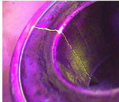
Figura 4.1: Immagine in cui si vede una cricca evidenziata tramite processo magnetic particle inspectio . Sulla cricca rimangono in sospensioni delle particelle magnetico-fluorescenti che creano la spaccatura bianco-gialla
