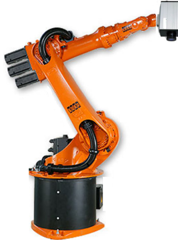
Figura 1.1: Immagine del sistema di acquisizione del progetto ThermoBot : su un braccio robotico è installata la termocamera per permettere di gestire distanze ed angolazioni per l'acquisizione delle immagini delle superfici del campione in esame.
