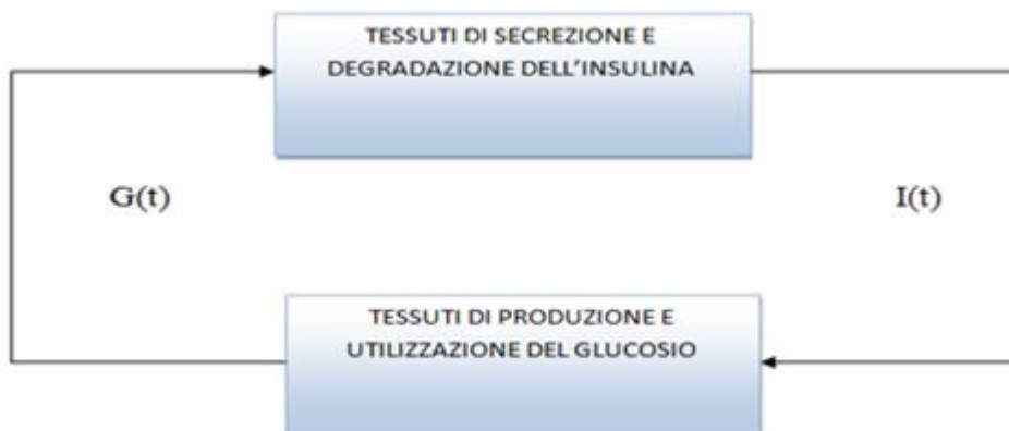
Figura 1.4: Schema del controllo in catena chiusa del sistema glucosio-insulina.
