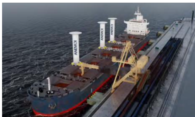
Figura 3. 7: Nave a rotore con guida trasversale [12]
