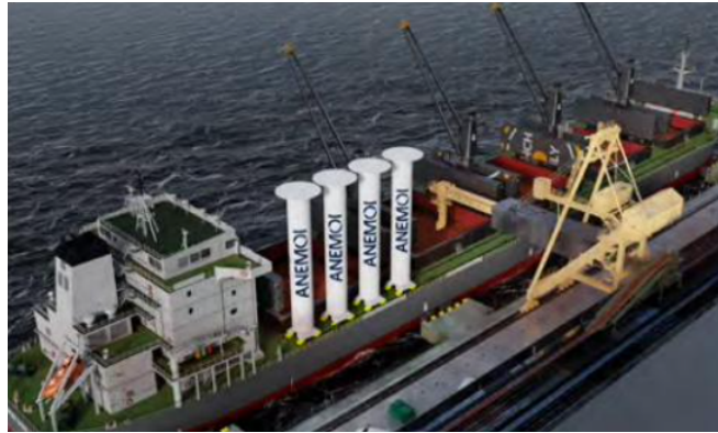
Figura 3. 8: Nave a rotore con ferrovia longitudinale [12]
