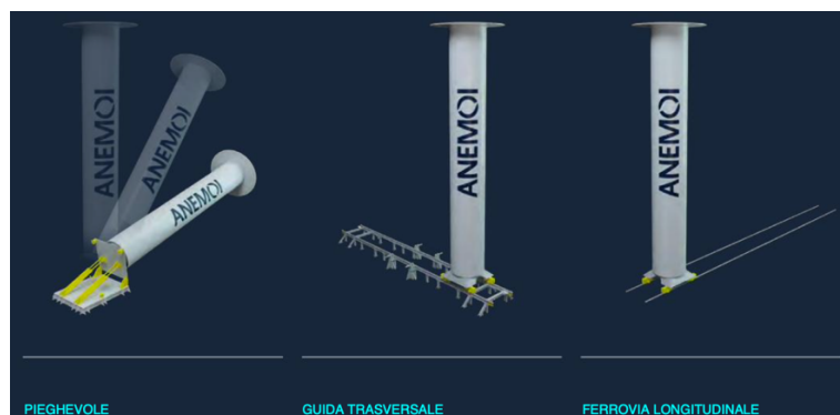
Figura 3. 5: Opzioni di installazione dei rotori Anemol [12]
