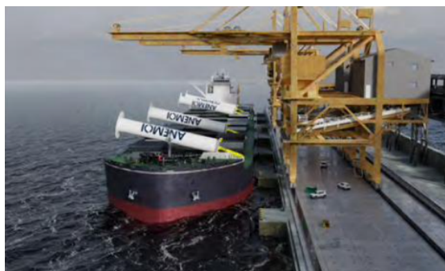
Figura 3. 6: Nave a rotore con soluzione pieghevole [12]
