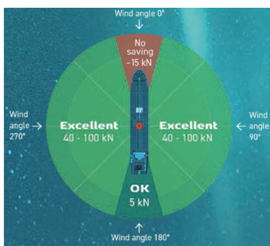
Figura 3. 15: Schema sull'angolo del vento rispetto alla nave [18]
