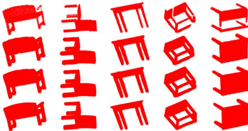
Figure 44: risultati qualitativi della ricostruzione 3D sui dati di test CV. Dall'alto in basso, immagine di profondità, predizione grossolana ottenuta dalla rete encoder-decoder, predizione dettagliata ottenuta dalla rete neurale, forma originale e reale
