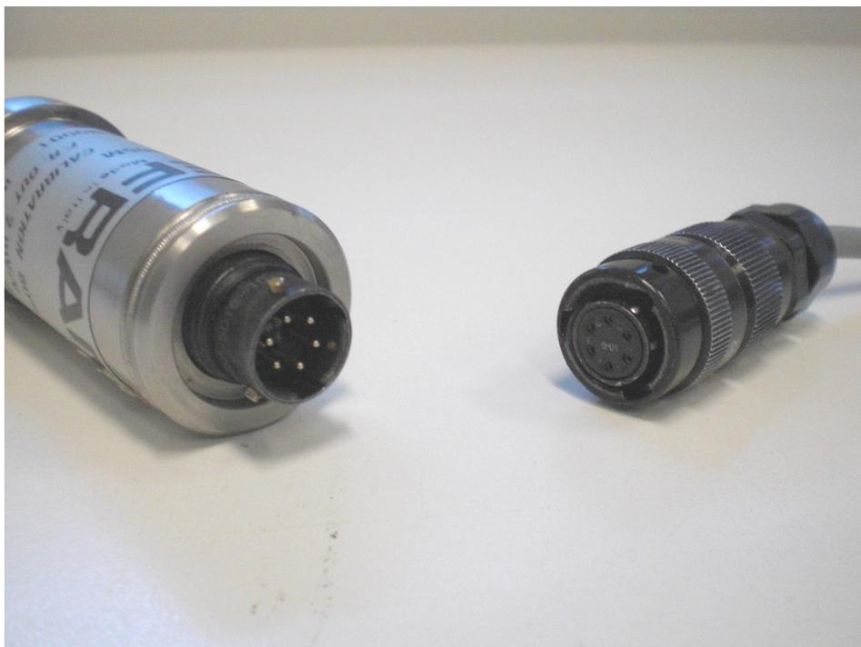
**Fig 2.8: particolare del connettore a 6 poli e del relativo attacco**
