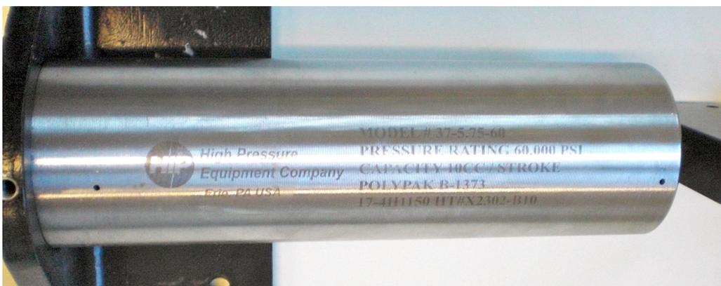
Fig 2.3: Particolare del corpo principale
