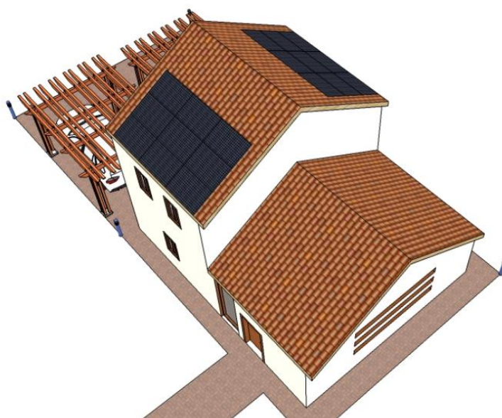
Figura 3.14 Vista tridimensionale dell'edificio con l'impianto fotovoltaico.
