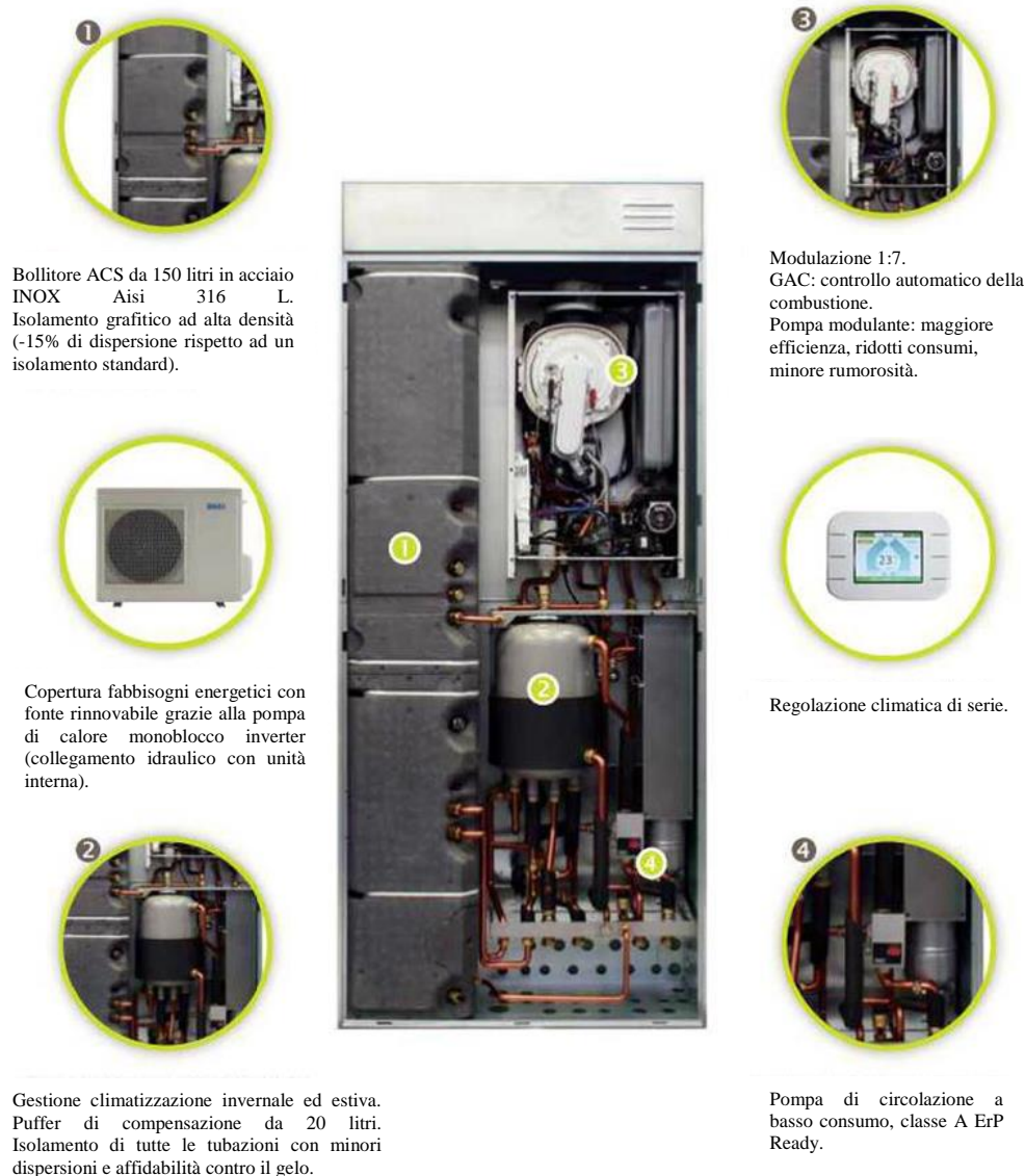
Figura 2.14 Componenti del sistema ibrido Duo-Tec CSI-i IN
