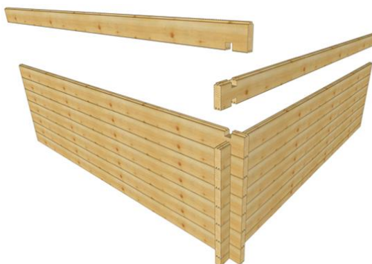
Figura 3.6 Sistema di costruzione Blockhaus.
