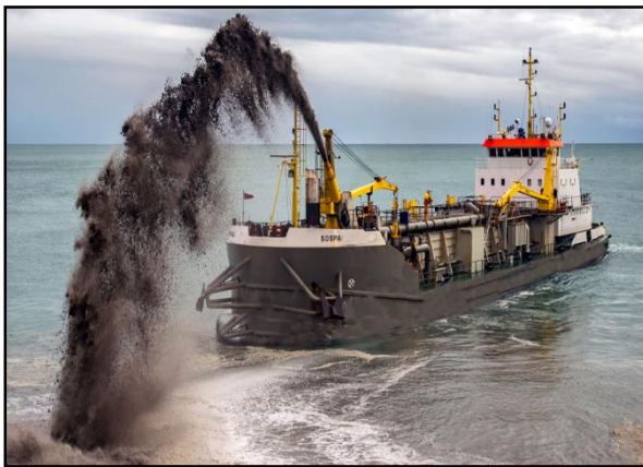
Figure 12 : Rejet de surface ou rainbowing (Baldock, 2010)
