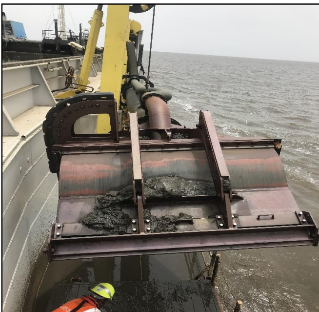
Figure 23 : Bouche d'aspiration de l'élinde
