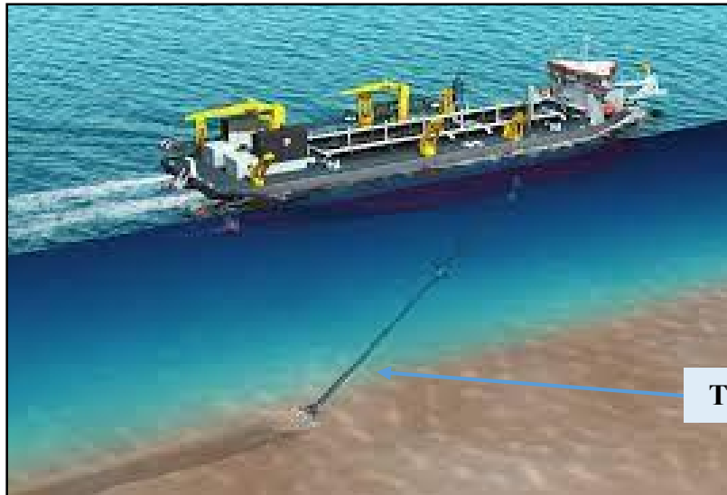
Figure 10 : Drague aspiratrice en marche (IADC, 2014)
