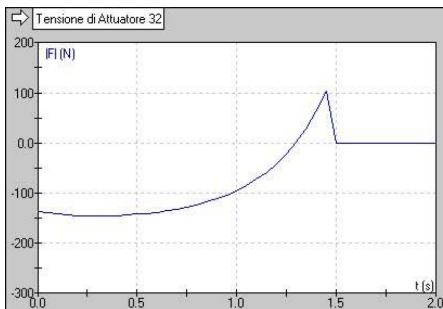
fig 48 Tensione sull'attuatore lineare
