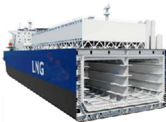
Figura 3.6 – Sistema serbatoi di stoccaggio del tipo Self Support Prismatic type B .
