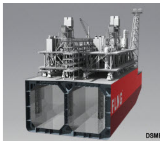
Figura 2.8 – Esempio di cisterne integrate.
