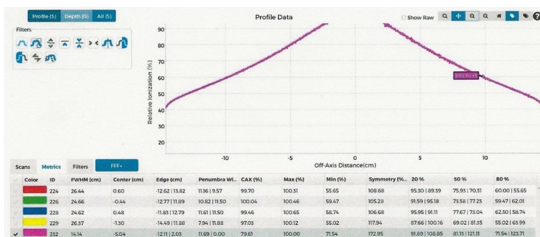
Figura 4.1 Dettaglio di un profilo di dose di un campo FFF misurato con DoseView 3D prima dell'aggiornamento software. Si nota come il valore della Symmetry e quello della dose sui vari punti notevoli risultino sproporzionati rispetto ai valori accettabili.
