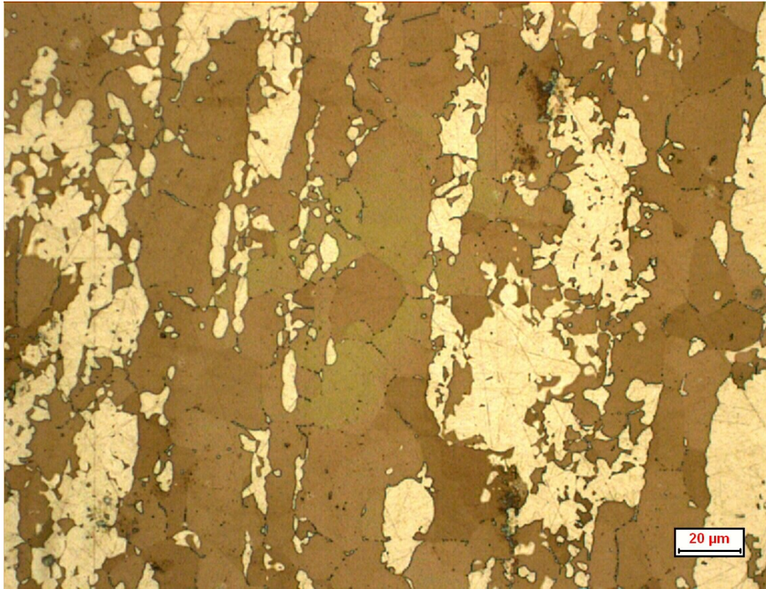
Fig. 3.25: Micrografia OM campione trattato isotermicamente a 950°C, sezione L, 500x.
