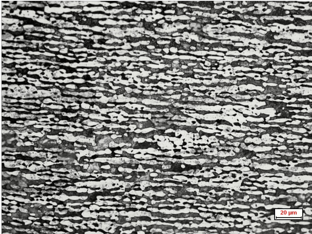
Fig. 3.7: Micrografia OM campione solubilizzato a 1020°C, sezione TC, 500x.
