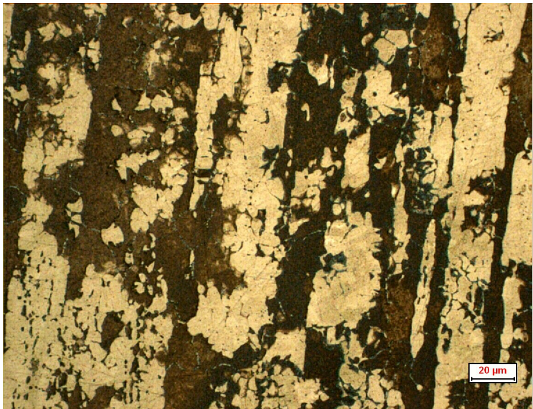
Fig. 3.24: Micrografia OM campione trattato isotermicamente a 900°C, sezione L, 500x.
