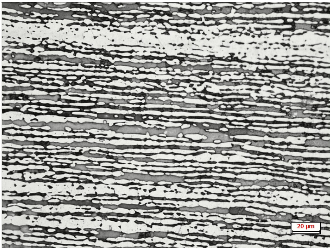
Fig. 3.8: Micrografia OM campione solubilizzato a 1020°C, sezione TL, 500x.
