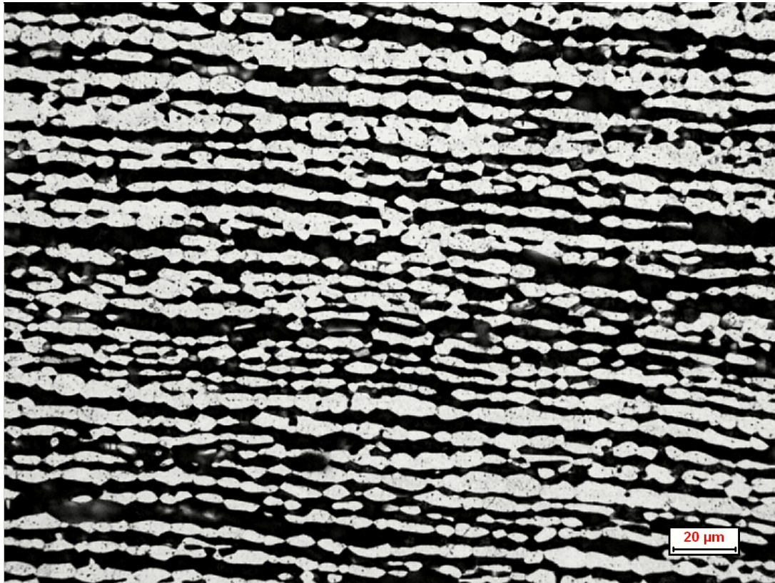
Fig. 3.11: Micrografia OM campione solubilizzato a 1050°C, sezione TL, 500x.
