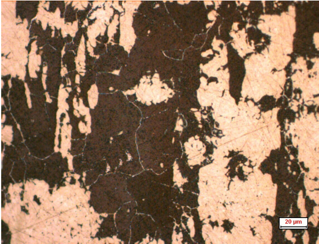
Fig. 3.23: Micrografia OM campione trattato isotermicamente a 850°C, sezione L, 500x.
