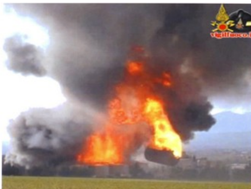
Foto 4. Proiezione del Serbatoio 93 a seguito di esplosione immortalata dai VV.F. intenti a spegnere l'incendio seguito all'esplosione del Serbatoio 95
