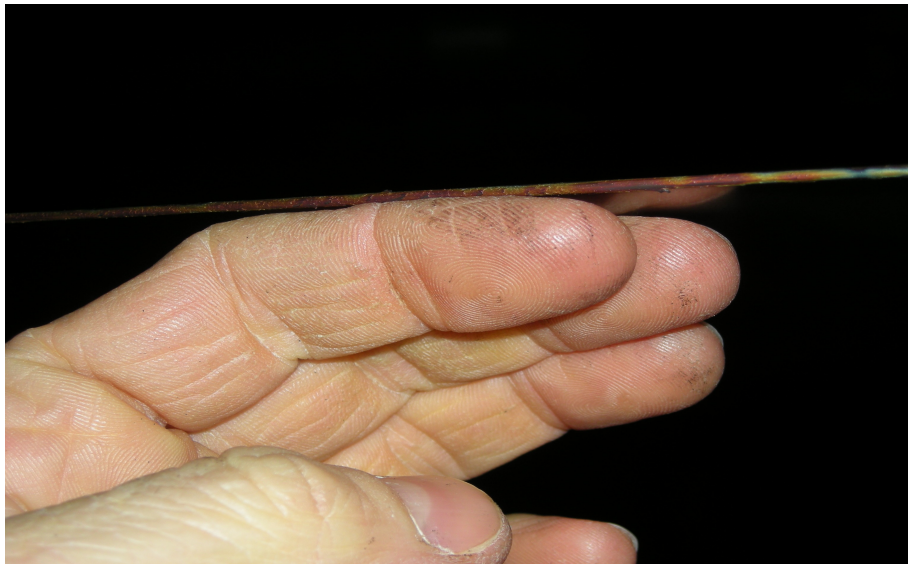
Figura 5. Dettaglio della colorazione del bordo laterale del nastro, ThyssenKrupp Torino
