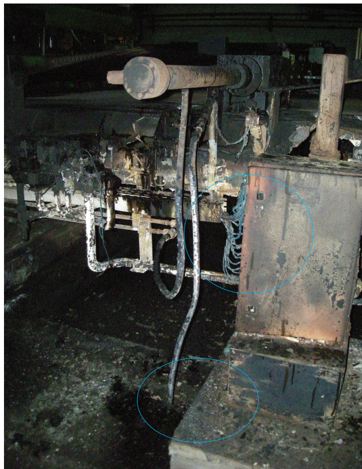
Foto 8. Dettagli di flessibili sfilati e collassati, ThyssenKrupp Torino
