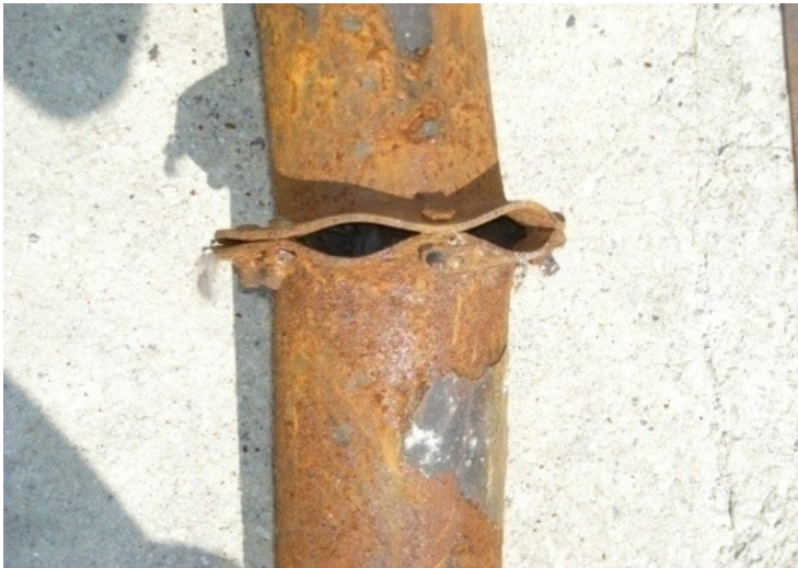
Foto 10. Danni da sovrappressione a carico di una flangia del tubo di ripompaggio, Molino Cordero
