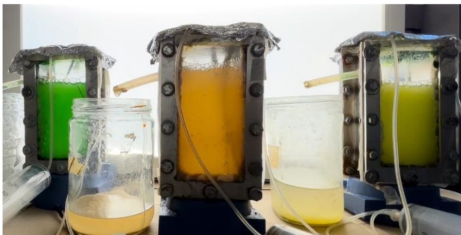
Figura 3.12 Fotobioreattori rappresentativi delle tre condizioni sperimentali con diversi rapporti luce/carbonio organico. Da sinistra a destra: rapporto luce/carbonio di 1,3 mol g_C^{-1} (coltura verde), 0,13 mol g_C^{-1} (coltura gialla) e 0,30 mol g_C^{-1} (coltura intermedia). L'immagine evidenzia le variazioni cromatiche delle colture, indicative dei diversi metabolismi predominanti.
