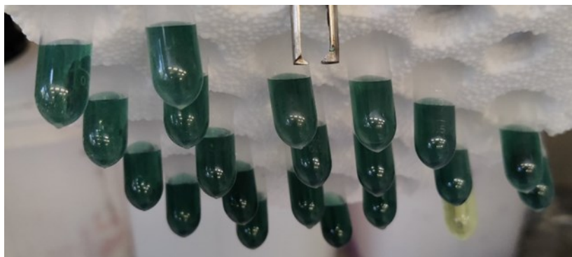
Figura 2.14 Immagine dei campioni di carboidrati di G. sulphuraria a seguito della reazione colorimetrica. Notare come i campioni di biomassa reagiti presentino colorazione verde, mentre il bianco mantiene una colorazione differente in quanto non è interessato da alcuna reazione.
