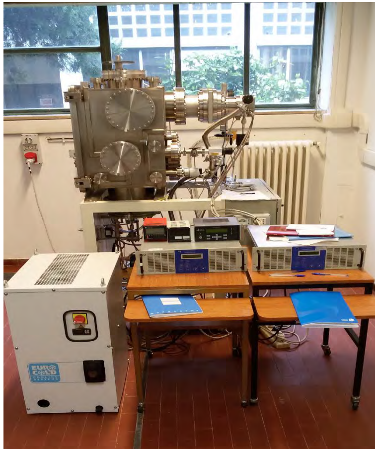
Figura 6.4: Visione d'insieme sistema magnetron sputtering di laboratorio
