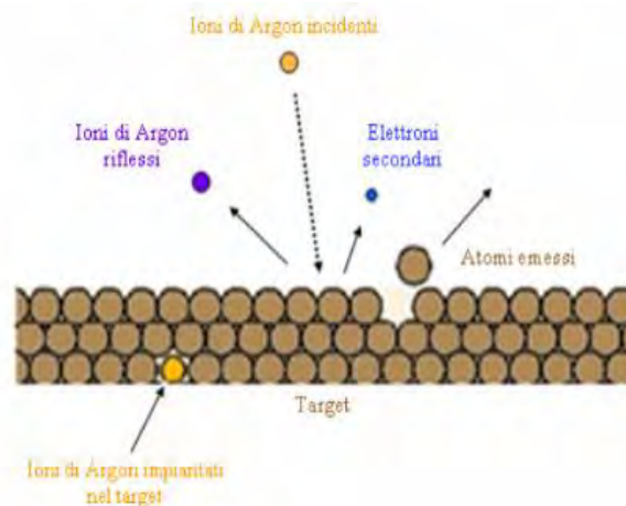
Figura 3.6: Rappresentazione del fenomeno dello sputtering [6]
