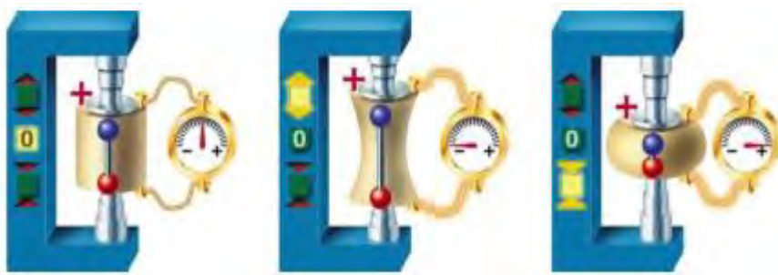
Figura 2.2: Effetto piezoelettrico diretto [12]
