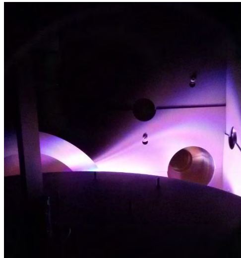
Figura 6.10: Scarica a bagliore osservata durante la deposizione del primo deposito
