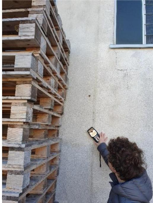
*Figura 5: Foto scattata durante uno dei rilievi materico-strutturali, finalizzati a fornire al progettista strutturale una identificazione completa delle tipologie costruttive che costituiscono il fabbricato. In particolare, si stava utilizzando un rilevatore di metalli così da verificare la corrispondenza delle armature tra elaborati progettuali depositati al Genio civile e quanto realmente realizzato.*
